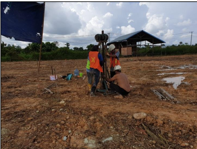
Pengujian Sondir
