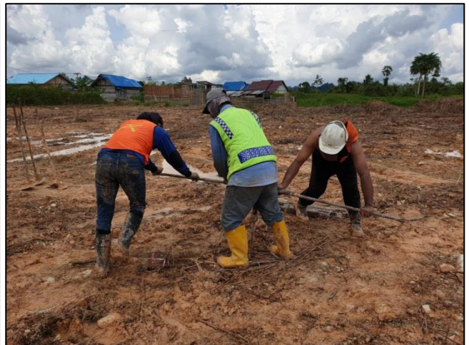
Pengujian Sondir
